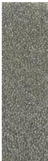
Figura 19: Electrodo reticulado de níquel (Ni), acoplado al reactor tipo filtro prensa con dimensiones de 19.0 mm de ancho, 193.0 mm de largo y 1.0 mm de espesor.
